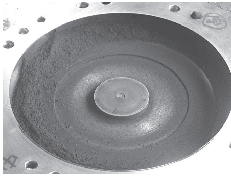
(a)従来型ジェットミル (多くの粉体堆積が見られる)
