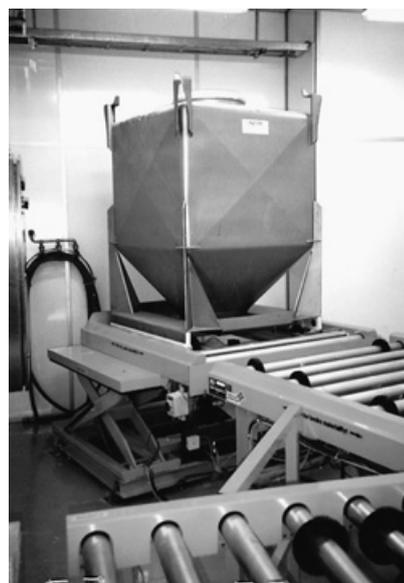
図-7 ローラーコンベアによる粉体容器の搬送
