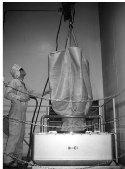
図-4 フレキシブルコンテナからの粉体の排出作業
